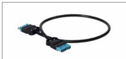
Skarvledning Wieland, 5-polig, 1-fas + ljusreglering. 5x1,5 mm 2 . L= 1.0 m, 2.0 m, 2.5 m, 3.0 m.
