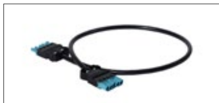
Koppelsnoer Wieland, 5-polig, 1-fase + lichtregeling. 5 × 1,5 mm 2 . L= 1,0 m, 2,0 m, 2,5 m, 3,0 m.
