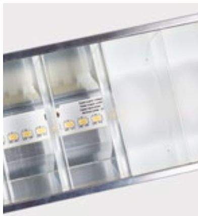
Ved at fordele luminansen fra LED-modulerne har vi skabt en lysende flade, som er behagelig for øjnene og som forhindrer blænding.
