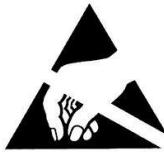
Produkten innehåller elektronik som kan vara känslig för såväl elektrostatisk urladdning (ESD) som mekanisk påkärrning. Direkt beröring (via hand eller verktyg) av åtkomliga kretskort typ LED-moduler skall undvikas.
