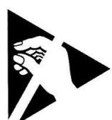
Das Produkt enthält Elektronik die empfindlich für elektrostatische Entladungen (ESD) sowie mechanischer Belastung sein kann. Um Schäden zu vermeiden, sollten offene Platinen sowie LED-Module nie direkt mit der Hand oder mit einem Werkzeug berührt werden.
